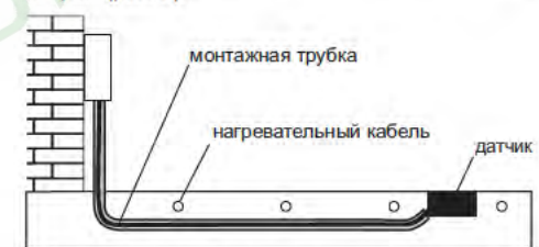
Рисунок 2. Способ монтажа датчика осадков при подогреве грунта.
