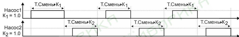
Рисунок 3.5 - Работа насосов при одинаковых коэффициентах хода
