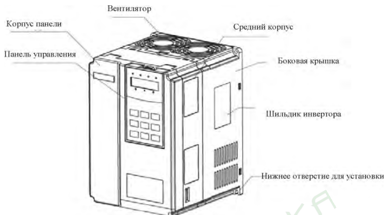
Рис.3.2. Внешний вид, габаритные и монтажные размеры Преобразователя 200MN[03] в пластиковом корпусе
