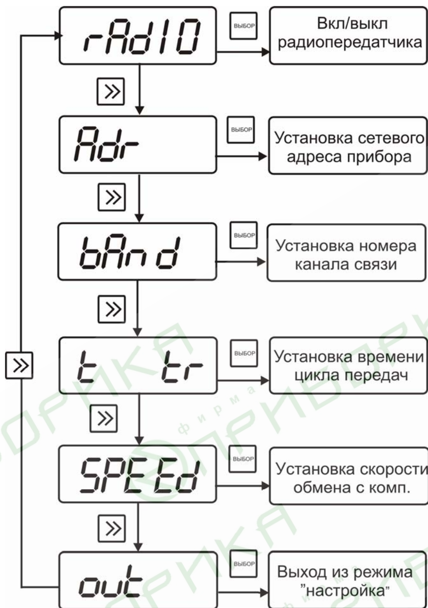
Рисунок 17 Общая схема режима “НАСТРОЙКА”
