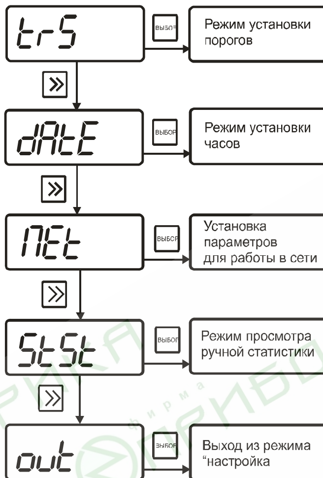
Рисунок 6 Общая схема режима “НАСТРОЙКА”
