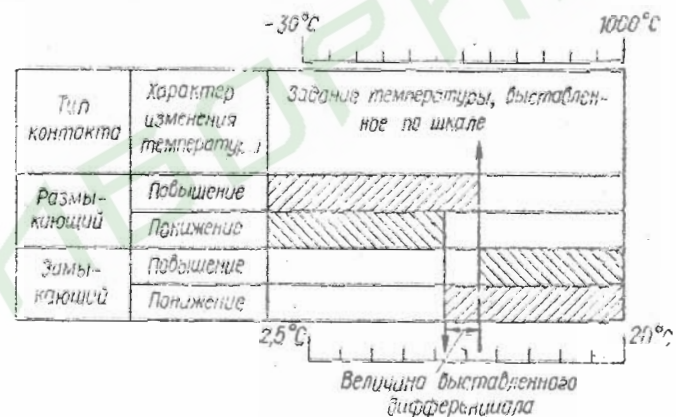
Рис. 4. Диаграмма работы контактного устройства ТУДЭ
