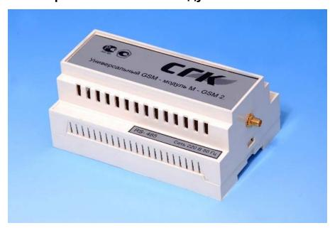
Универсальный GSM – модуль предназначен для работы в составе системы автономного контроля загазованности и выполняет функцию информирования диспетчера о состоянии системы с использованием GSM-связи посредством предачи SMS- сообщений:
