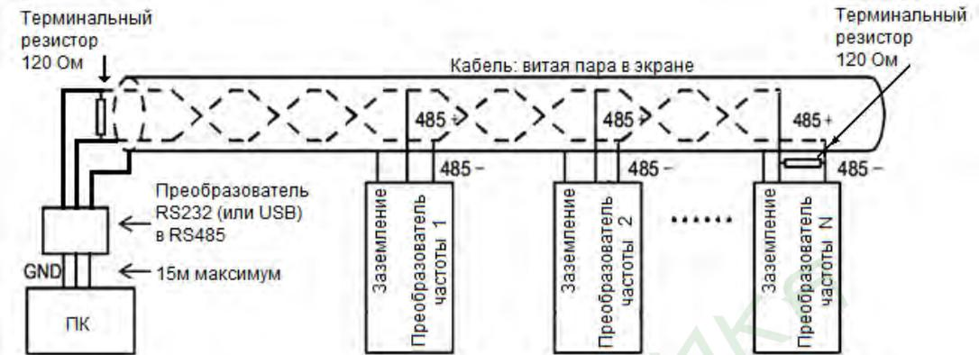
Схема подключения к RS485 нескольких преобразователей по последовательно-параллельной схеме
