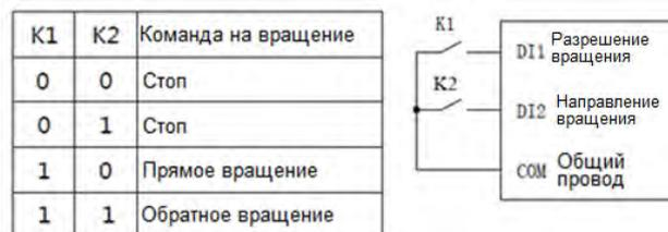
2: Трехпроводный режим типа 1. В этом режиме вход DI3 включает разрешение движения, а направление движения определяют сигналы на входах DI1 и DI2 соответственно. Установки при этом следующие:
