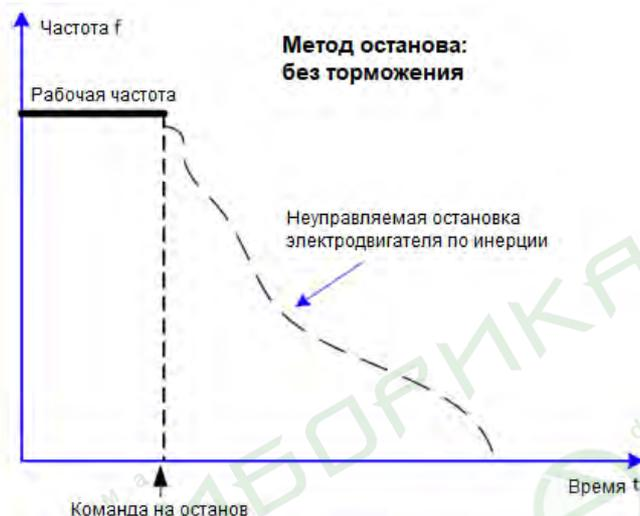
1: В этом случае выходной сигнал с Преобразователя отключается немедленно. Электродвигатель продолжает вращение по инерции с неконтролируемой скоростью и с неконтролируемым временем до останова.
