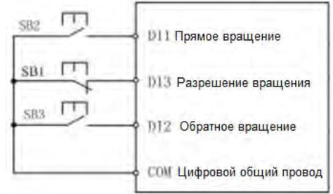
3: В трехпроводном режиме типа 2 вход DI3 является разрешающим операции, команда на вращение подается через вход DI1, а направление вращения задается сигналом на входе DI2. Установки следующие:
