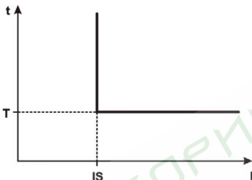
Рисунок 4 – Принцип защиты с независимой выдержкой времени
