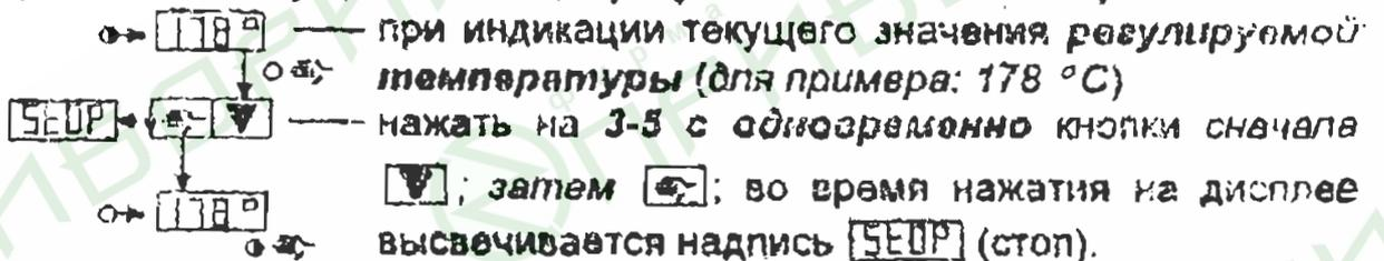
Через 3-5 с светодиоды: "O" - загорается, "O" - начинает мигать, что свидетельствует о прерывании программы (состояние "стоп"). После этого кнопки [E], [V] следует отпустить. На дисплее индицируется текущее значение регулируемой температуры.
