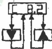
Установка нужного значения любого из параметров производится после вызова его на дисплей нажатием кнопки [▲] (для увеличения величины) или [▼] (для уменьшения величины) - см. примечание к п.5.2.2. Для примера показана установка значения коэффициента пропорциональности (список [Cont]).
