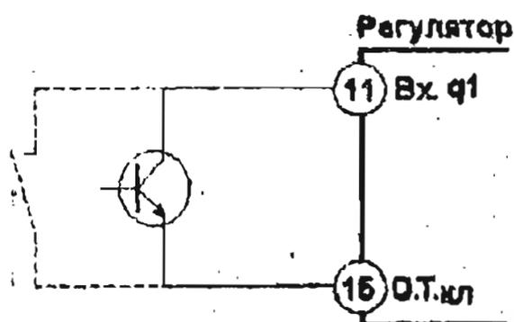
Показано подключение внешнего ключа к входу q1. Аналогично подключается внешний ключ к входу q2, при этом клемма 11 заменяется на клемму 10. Соединения выполняются отдельным жгутом, по возможности свитыми проводами.
