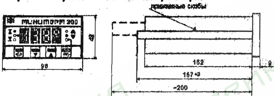
**Разметка отверстия под крепление регулятора:**
