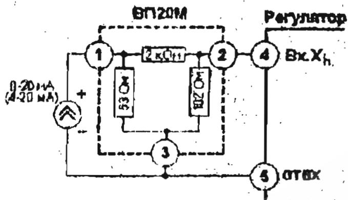
*Примечание.* Если вход  $X_n$  не используется, то клемма 4 соединяется перемычкой с клеммой 5.
