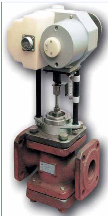
Регулирующий клапан с электрическим приводом РКЭП используется в качестве исполнительного устройства для комплектации систем автоматического регулирования тепловых процессов в контурах отопления, вентиляции и горячего водоснабжения на объектах теплоснабжения.
