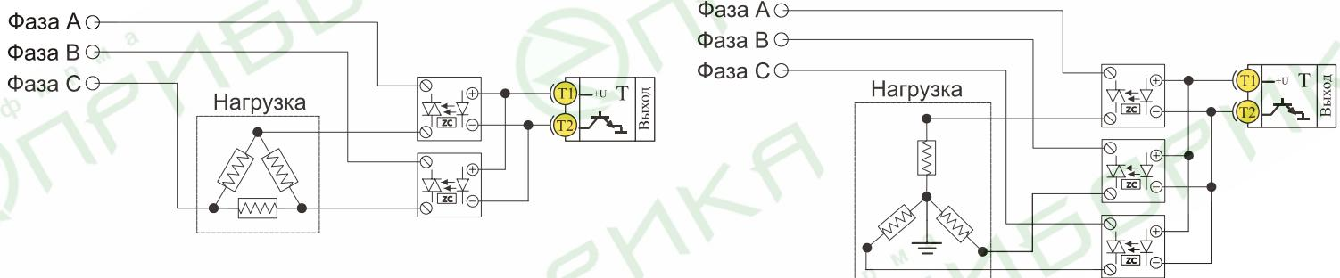
К релейному выходу кроме аварийной сигнализации, как это показано на схеме выше, можно подключить электромагнитный пускатель, управляющий нагревателем. В этом случае на транзисторный выход следует подключить, например, аварийную сигнализацию
