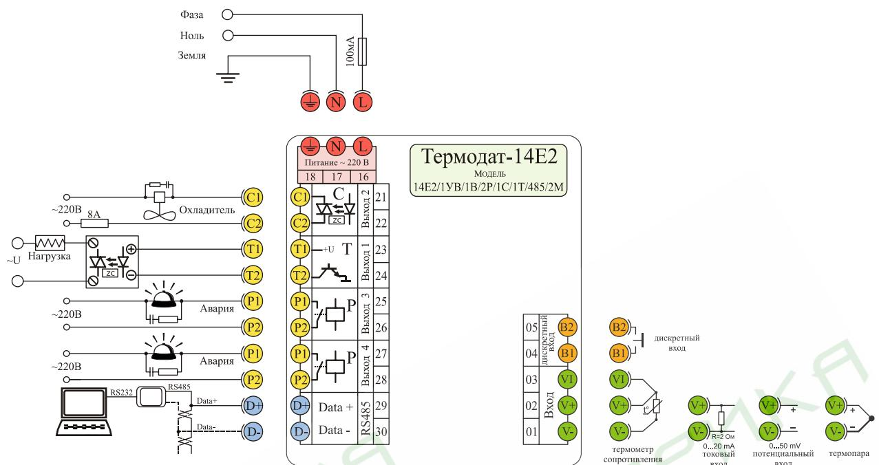
К транзисторному выходу кроме однофазных блоков, как это показано на схеме выше, можно подключить и двухфазные, и трехфазные блоки СБ
