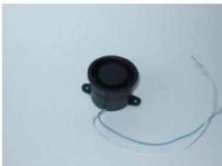
Предназначена для подачи звуковых сигналов с высокой различимостью на фоне акустических шумов на различных объектах в помещении.
