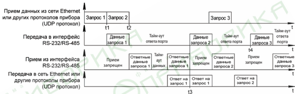
Рисунок 4.7 – Диаграмма работы прибора в режиме «запрос – ответ»
