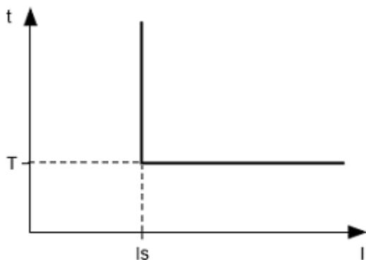
Рисунок 2.2 - Принцип защиты с независимой выдержкой времени
