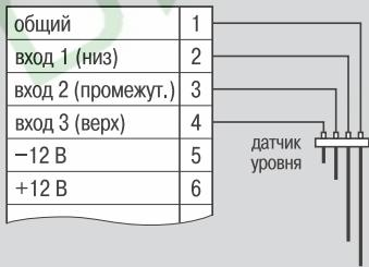
Схема подключения кондуктометрических датчиков уровня
