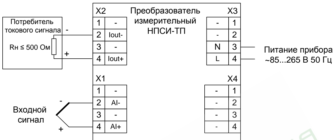
Рисунок 3 – Электрическая схема подключения преобразователя
