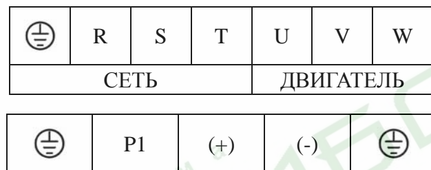
Рис. 4.6 Расположение силовых клемм преобразователей мощностью от 350 до 630 кВт
