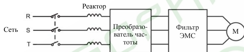
Рис. 4.10 Подключение выходных цепей
