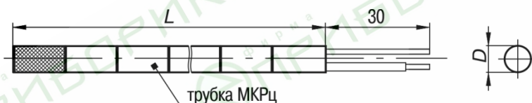
Рисунок Г.4 – Конструктивное исполнение 021.1Э с изолированным рабочим спаем
