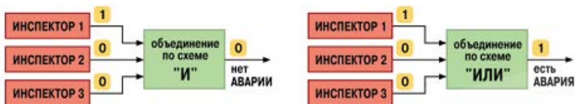
Рисунок 3.21 - Логика принятия решения об аварии
