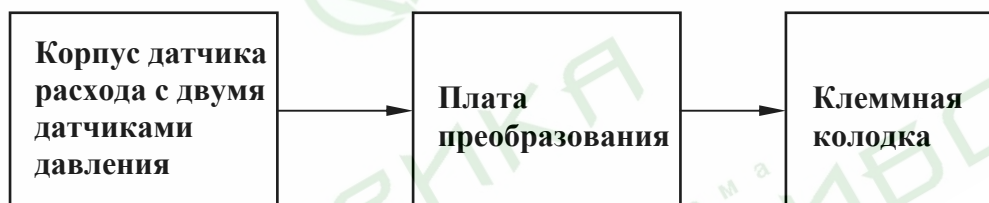
Рисунок 1 - Структурная схема датчика расхода
