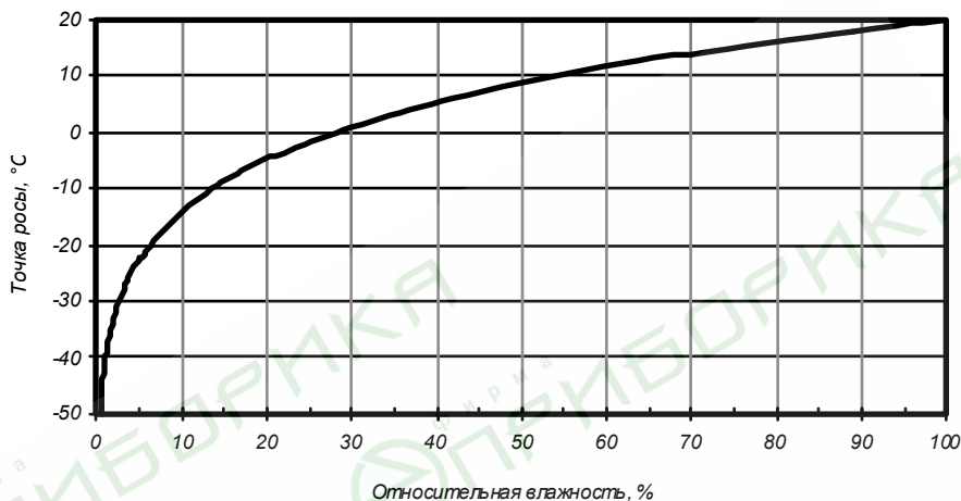
Рис.3. Зависимость точки росы газа от его относительной влажности при температуре газа 20^{\circ}\text{C} .
