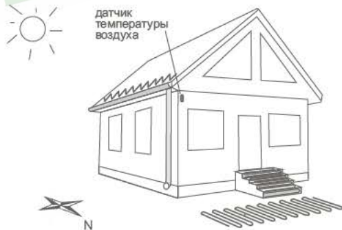
Рисунок 1. Монтаж датчика температуры воздуха
