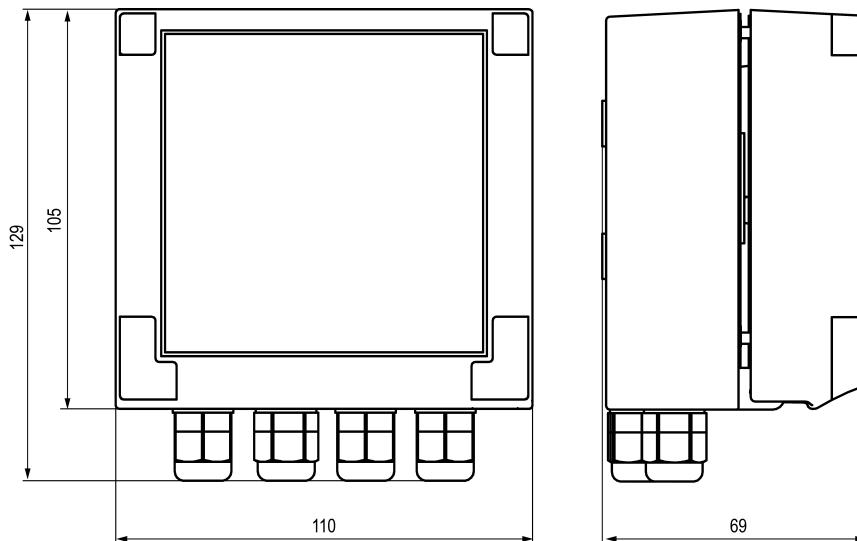
Рисунок 4.14 – Габаритные размеры прибора в корпусе Н
