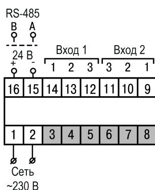
Рисунок 5.4 – Общая схема подключения 2TPM0-Щ5
