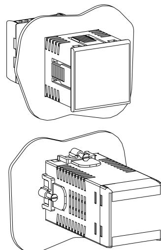
**Рисунок 4.7 – Монтаж прибора щитового крепления Щ5**
