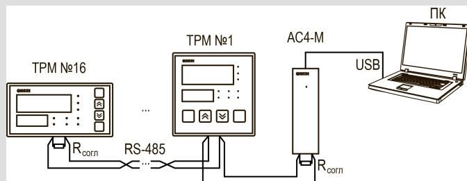
Рисунок 5.7 – Подключение приборов по сети RS-485
