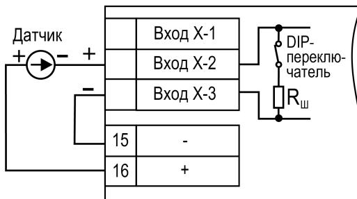
**Рисунок 5.8 – Подключение токового датчика с питанием от ИП24**
