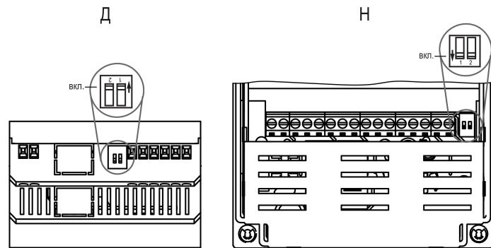
Рисунок 5.15 – Расположение DIP-переключателей для корпусов Д и Н
