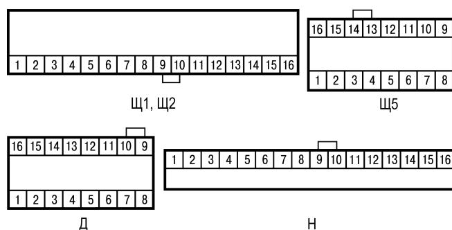
Рисунок 7.5 – Установка перемычки
