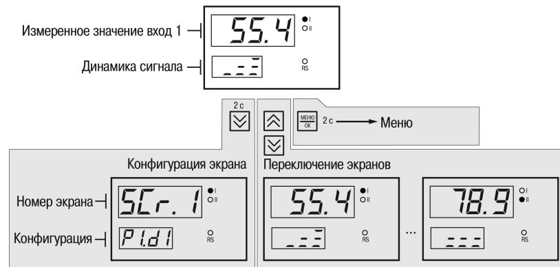
Рисунок 6.5 – Схема переходов с главного экрана
