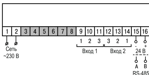
Рисунок 5.3 – Общая схема подключения 2TPM0-Щ1/Щ2
