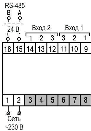
Рисунок 5.5 – Общая схема подключения 2TPM0-Д
