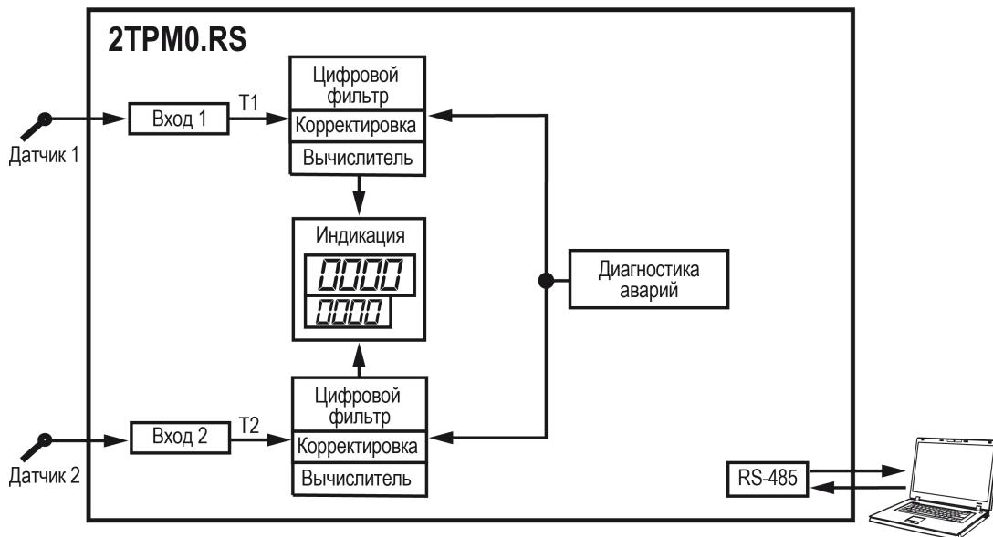
**Рисунок 6.1 – Функциональная схема**
