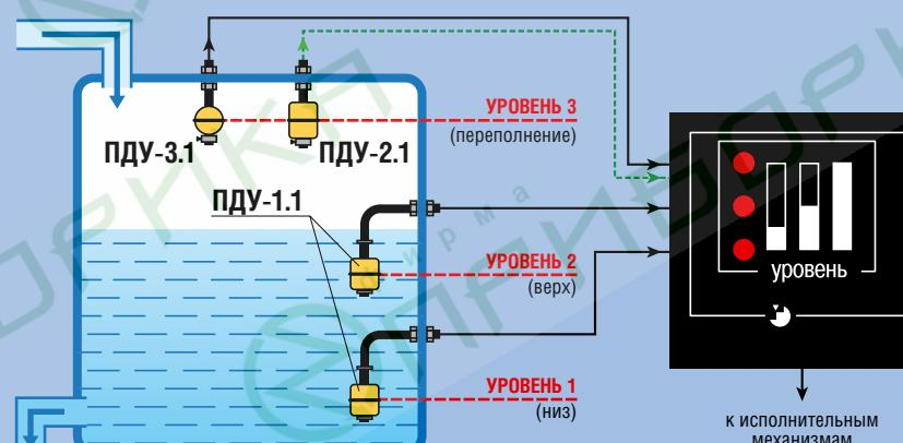
Если резервуар имеет конструкцию, показанную на рисунке, то возможен вариант вертикального крепления трех датчиков ПДУ-2.1 или ПДУ-3.1 с отслеживанием промежуточного уровня.
