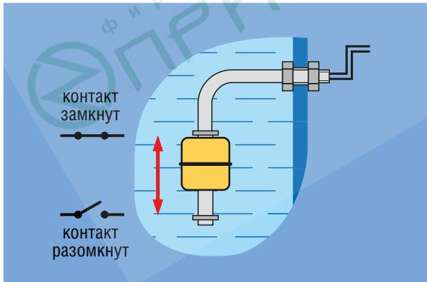
Датчик имеет поплавок, передвигающийся по вертикальному штоку. Внутри поплавка находится постоянный магнит, а в штVOKE, представляющем собой полую трубку, находится коммутирующий элемент – геркон. Состояние геркона определяется положением поплавка датчика. Переключение происходит при совпадении положения поплавка с положением геркона.
