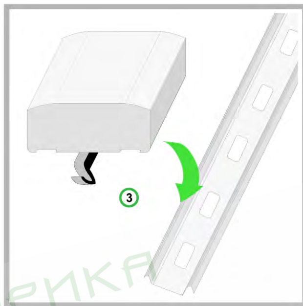
Рис. 3.5 Установка устройства на DIN-рейку без использования комплекта крепежа iRZ
