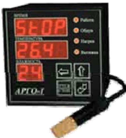
Измерители-регуляторы АРГО-1 и АРГО-2 предназначены для управления сушильными шкафами с температурой обработки до 80°C. Управляют нагревательными элементами (ТЭН) для поддержания заданной температуры, вытяжным вентилятором для удаления избытка влаги и обдувочными вентиляторами для создания равномерного теплового баланса.
