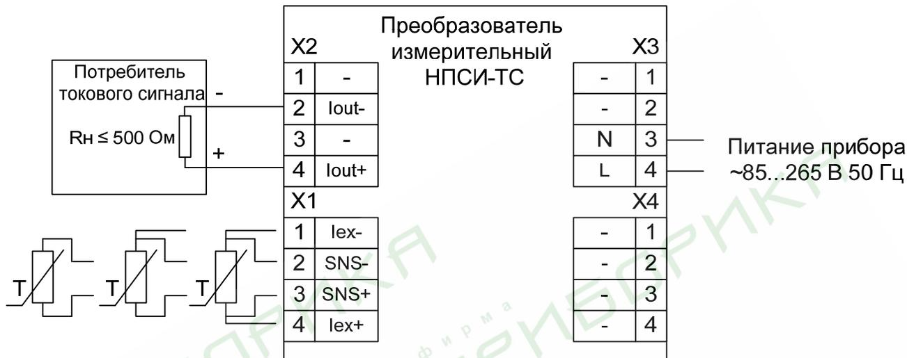
Рисунок 3 – Электрическая схема подключения преобразователя
