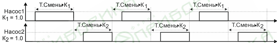
Рисунок 3.5 - Работа насосов при одинаковых коэффициентах хода
