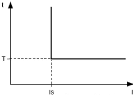
Рисунок 1.2 - Принцип защиты с независимой выдержкой времени
