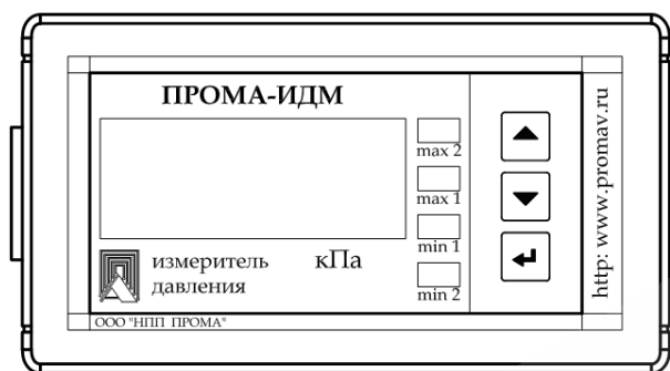
Рис.2б. Внешний вид измерителя ПРОМА-ИДМ исполнение «Щ» - щитовое (вид спереди).
