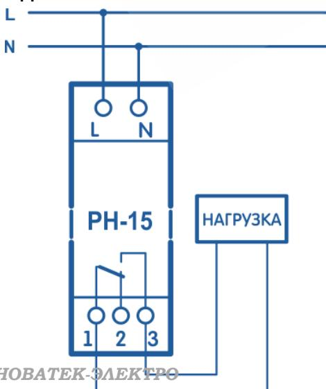
Для надежного контакта необходимо производить затяжку винтов клеммника с усилием 0,4 Н·м.
