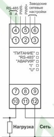
Рисунок Б.1 – Подключение прибора к однофазной сети
