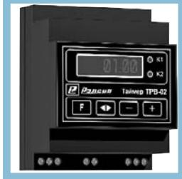
Таймер представляет собой программируемое автоматическое устройство и предназначен для ежесуточного замыкания и размыкания до двух внешних цепей в соответствии с заданными уставками по времени и уровню освещенности с индикацией реального времени.
