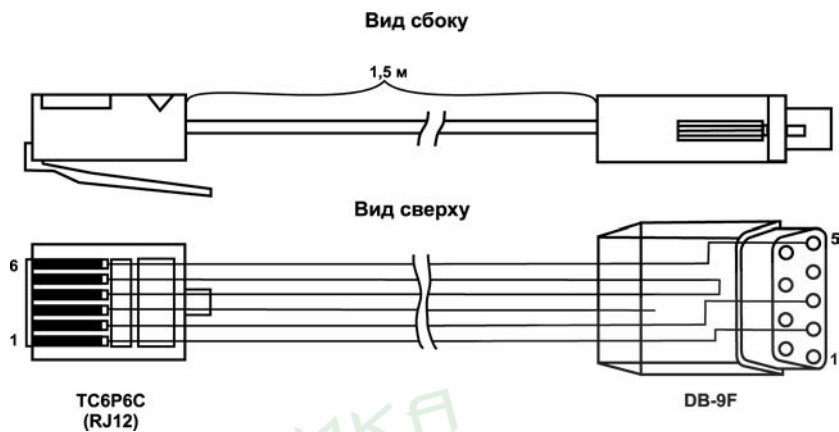
Рисунок Д.1 – Схема кабеля КС1
