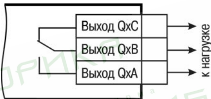
Рисунок 6.1 - Схема подключения нагрузки к ВЭ типа Р
