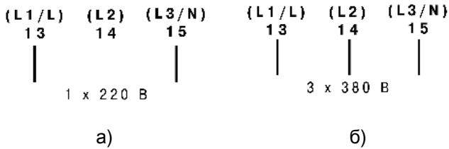
Рисунок 5.2 – Однофазное (а) и трехфазное (б) проводные соединения (для однофазного соединения клемма 14 (L2) – заглушена)
