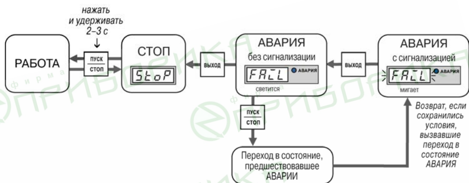
Рисунок 6.2 – Схема переключения состояний прибора
