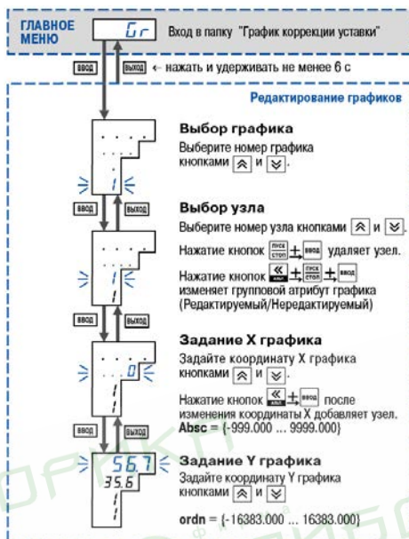
Рисунок 12.24 – Задание и редактирование графика коррекции уставки
