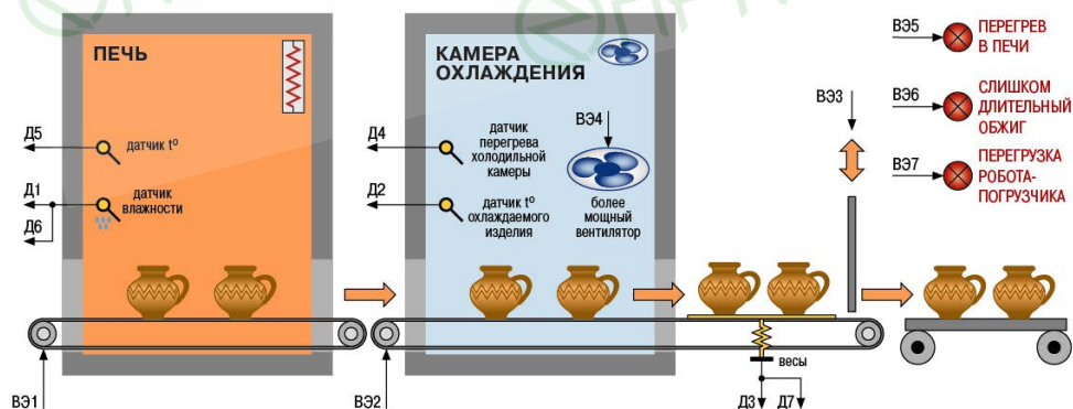
Рисунок 4.4 – Использование 8-канального регулятора TPM148 2-ой модификации в автоматизированном процессе обжига глиняных изделий
