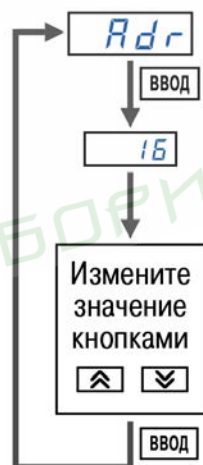
Рисунок 12.5 – Схема изменения значения параметра
