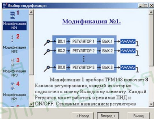
Рисунок 11.2 – Мастер выбора конфигураций. Окно выбора конфигураций прибора
