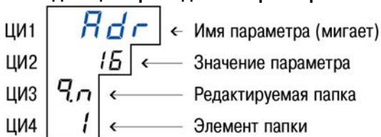
Рисунок 12.3 – Показания цифровых индикаторов при задании параметров
