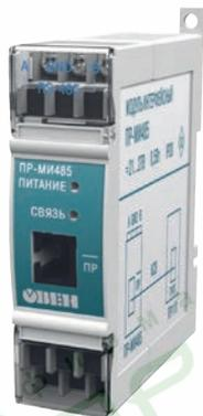
Модуль интерфейсный ПР-МИ485 позволяет производить подключение программируемого реле ОВЕН ПР к сети RS-485. Такая связка позволяет контролировать состояния внутренних переменных, отслеживать выполнение алгоритма, а также удаленно менять уставки, переключать режимы и т.п.
