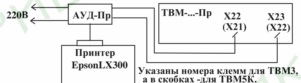
Рис.16. Подключение принтера к ТВМ. Здесь:АУД-Пр -адаптер удаленного доступа в исполнении «Пр».
