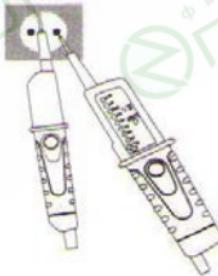
Во избежание срабатывания УЗО тест необходимо проводить между контактами L (фаза) и N (ноль) в течение примерно 5 секунд. Сразу после этого следует проверить напряжение между контактами L (фаза) и PE (заземление) (УЗО в этом случае не отключается).
