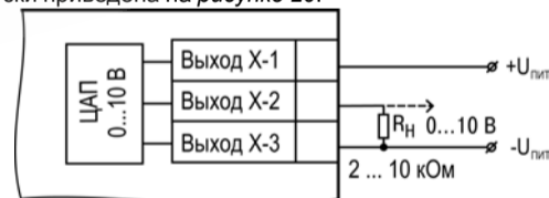
Рисунок 20 – Схема подключения нагрузки к ВУ типа У
