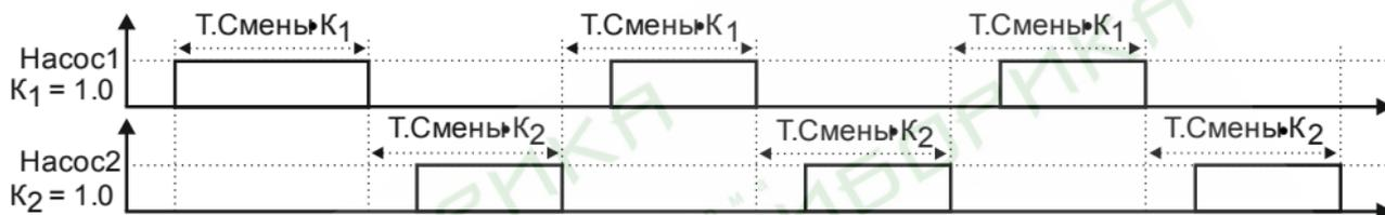
**Рисунок 3.5 - Работа насосов при одинаковых коэффициентах хода**
