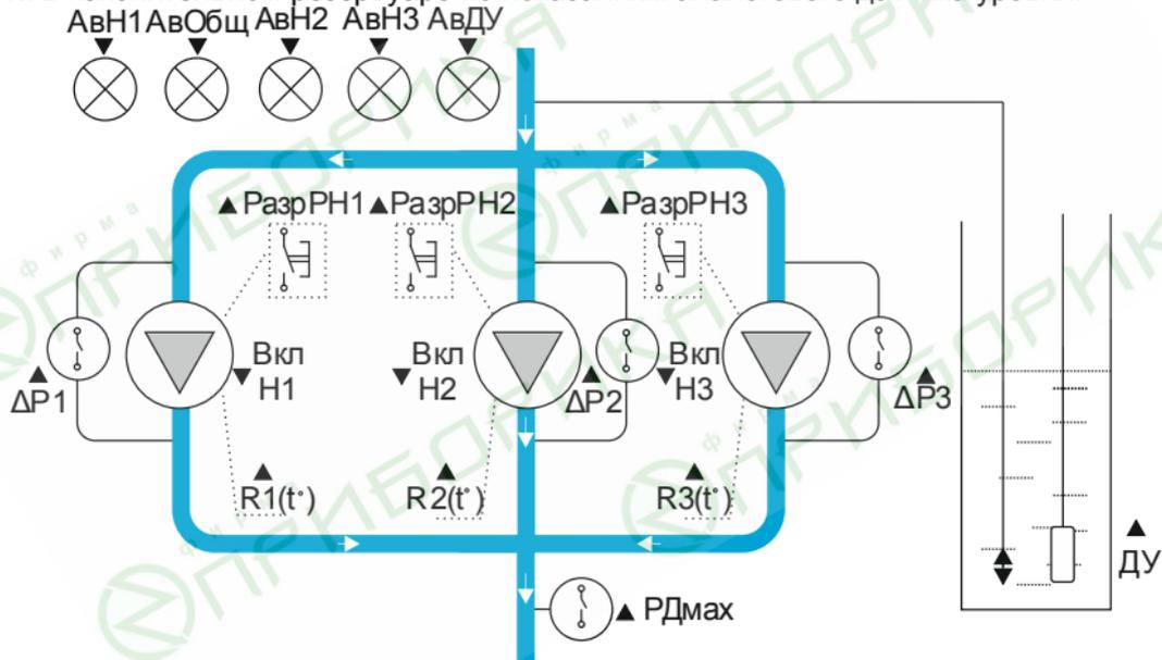
Рисунок 2.1 - Схема объекта управления (осушение)
