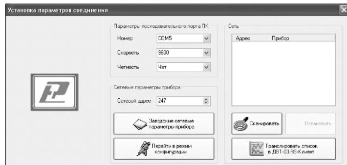
Программа - конфигуратор предназначена для настройки параметров приборов ДВТ-03 и ПАС-01. Имеет удобный графический интерфейс, позволяющий легко работать с программой.
