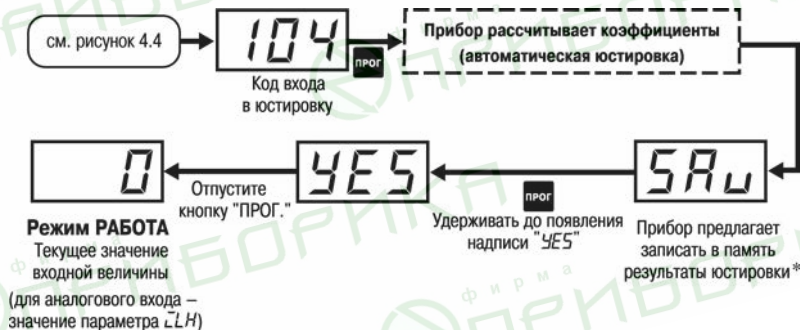
Рисунок Д.2 – Последовательность действий при калибровке наклона характеристики термопреобразователя или датчика с унифицированным выходным сигналом
