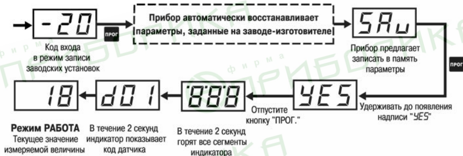
Рисунок 4.2 – Схема действий при восстановлении заводских установок
